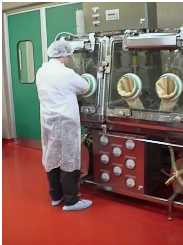
Fig. 2 Foto di un isolatore
