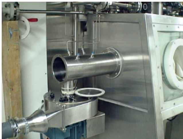
Figura. 24 - Dettaglio del sistema di filtrazione dell'aria espulsa e del relativo ventilatore che mantiene la depressione in un isolatore
