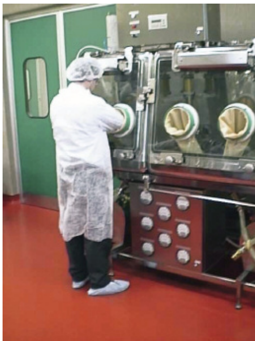
Figura. 22 - Foto di un isolatore
